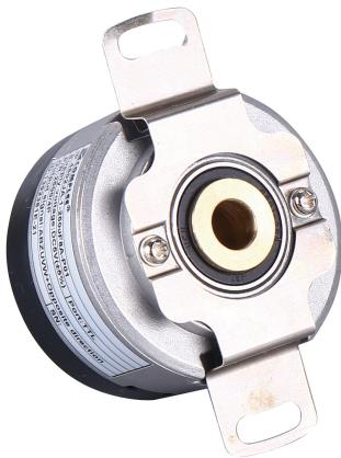
值编码器和增量式编码器有何区别？1：首先值编码器的码盘和增量型编码器的码盘存在差异，增量型编码器的码盘是在同一个圆周上有固定数量的光栅，通过光栅切割光线产生一定数量的脉冲（每圈上光栅的数量即为编码器所谓的分辨率）；而值编码器则在同样的码盘上在不同的圆周上有不同数量，不同间隔的光栅，即当码盘停在某个位置时，可以通过码盘上各圆周上的是否透光组合成固定的位置，经过输出线后显示的是一个固定的数字。2：当断电后增量型编码器无法记录当前的位置，只能配合计数器等设备记录。而值编码器本身可以记录位置，无用担心断电后的记录保存问题。3：值编码器具有多种输出码制（二进制码、十进制BCD码、格雷码），可以直接提供给显示单元PC等设备，而增量型编码器则无法直接提供给显示单元。4：值编码器几乎可以不考虑速度、干扰等问题，只要编码器停止在某个位置，不论转动中收到什么影响，终能显示当前位置。
